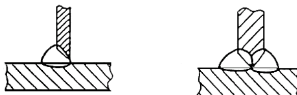
Рисунок А.4. Тавровое соединение
