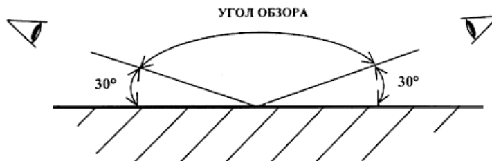
Рисунок 1. Условия визуального контроля
