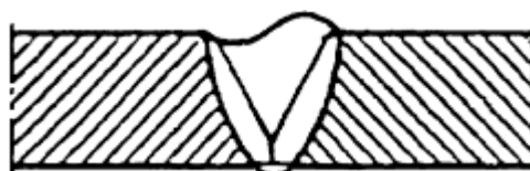
Рисунок А.47 Не полностью заполненная разделка кромок
