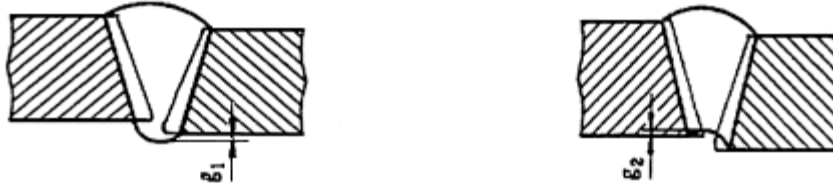
Рисунок 15 - Измерение выпуклости ( g_1 ) и вогнутости ( g_2 ) корня шва стыкового одностороннего шва
